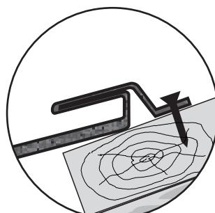
Detail 3.: Detail umiestnenia nastreľovacích klincov, alebo skrutiek do pásnice sedla panelu
