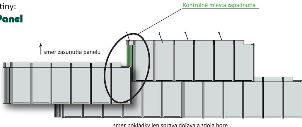
Schéma 1.: Šachovnicové ukladanie panelov v radoch.
